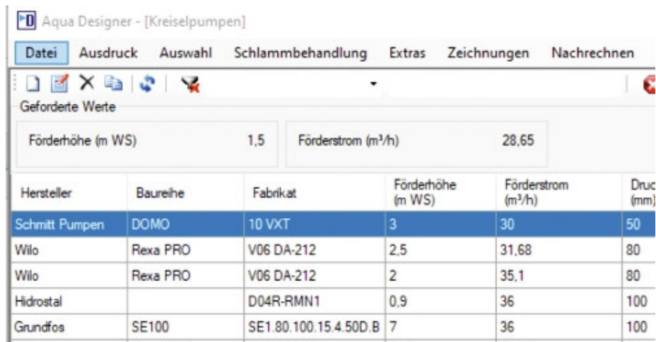
Abb. 188: Erforderliche Parameter für die Pumpen-Auslegung
