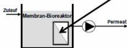
Abb. 156: Schema konventionelles und Membranbelebungsverfahren /66/
